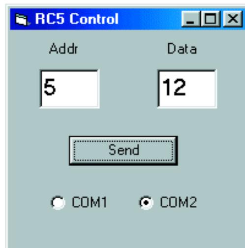
Bild 1. Ein Testprogramm für RC5-Signale.
